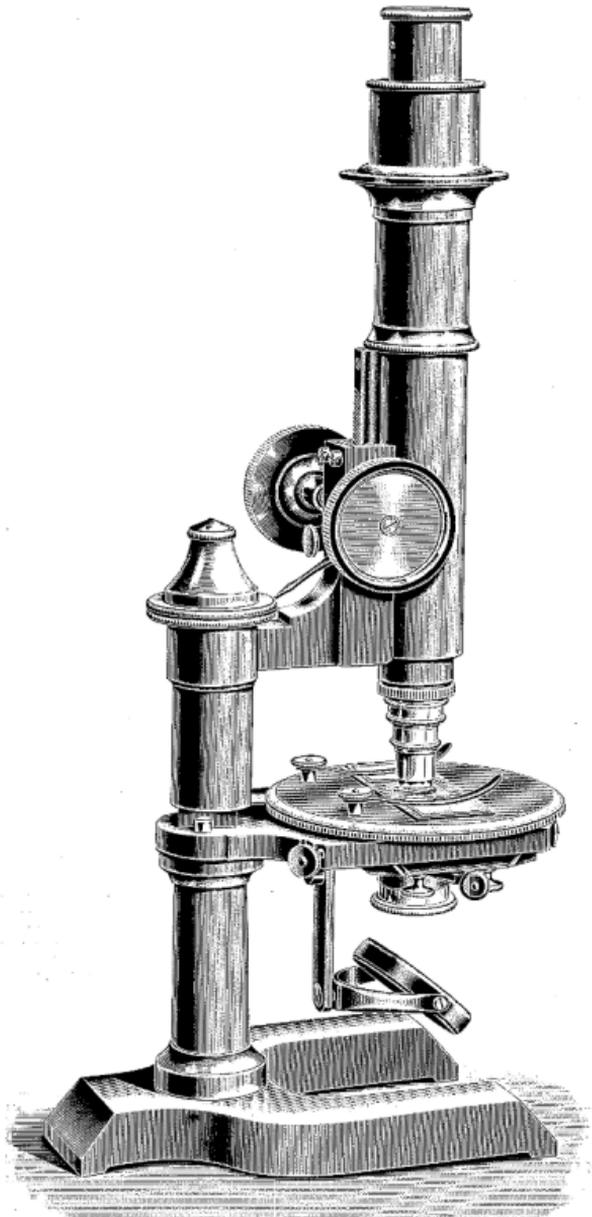
Fig. 17. Mittleres Polarisations-Mikroskop
